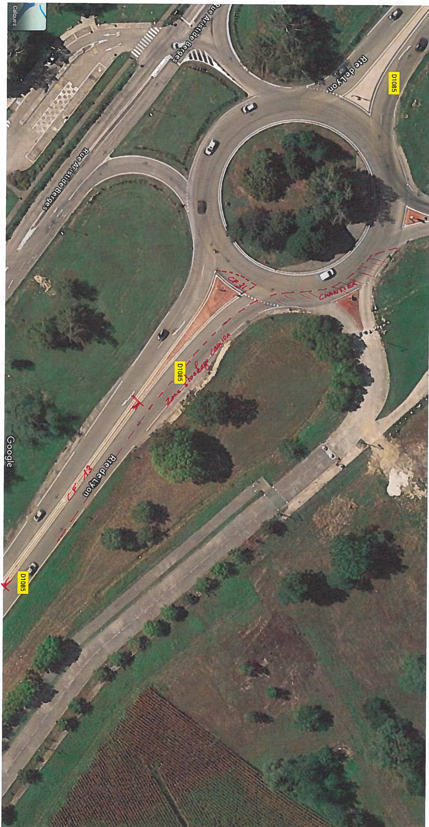
Schéma de ballisage chantier CAPV RD1085 giratoire centr'alp
