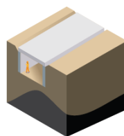
Terrassement réalisé en taube sous la traverse
