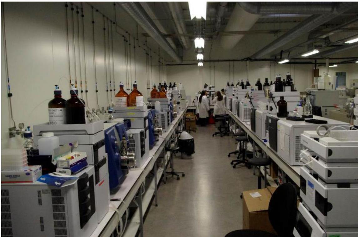
Une injection directe de l'échantillon d'eau sur le chromatographe en phase liquide suivie d'un passage en LC-MS-MS est effectuée afin d'éviter l'étape d'extraction parfois incompatible avec la nature du composé recherché. Nos laboratoires travaillent au développement de cette technique nécessitant un matériel extrêmement sensible.
