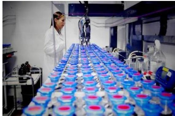
Elle est applicable aux eaux résiduaires (Méthode par dilution – DBO > 3 mg/L) et aux eaux propres (Méthode sans dilution – de 0.5 à 6 mg/L)
