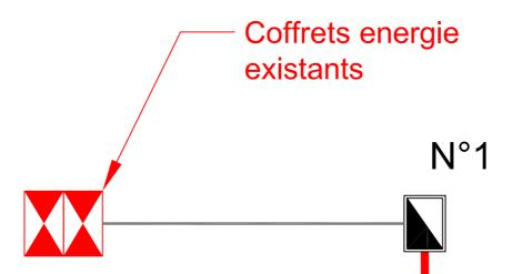
Câble U1000RO2V 2X10<sup>2</sup> à dérouler entre ETT et chambre N°1. Prévoir 4m de câble en sortie du massif afin de remonter dans la cabine ETT. Le love peut être laissé dans la chambre N°1.
