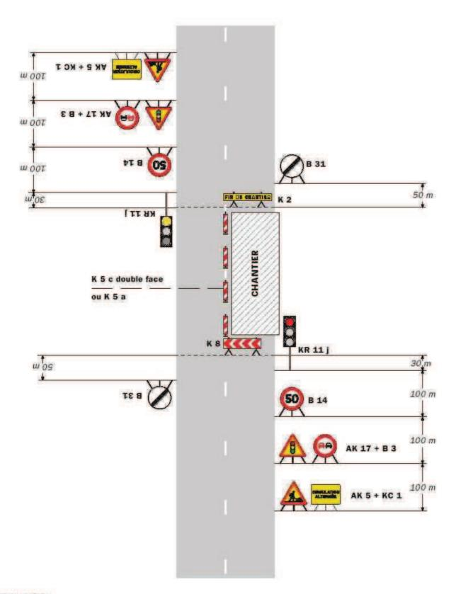
Schéma à appliquer notamment lorsque l'alternat doit être maintenu de nuit, en absence de visibilité réciproque.
