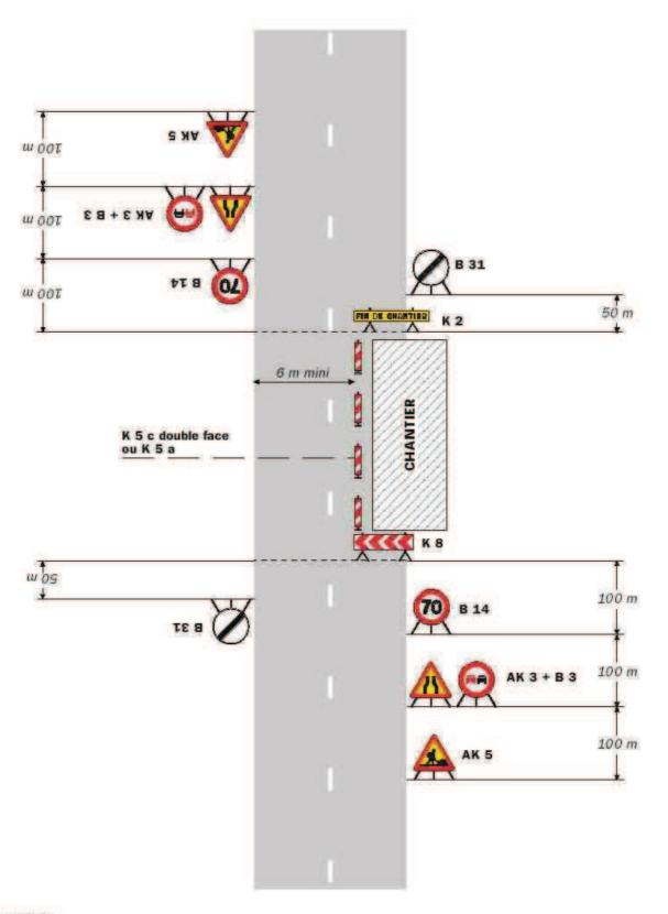
L'empiétement du chantier impose un déport de trajectoire notable pouvant chevaucher l'axe de la chaussée. Il permet cependant le croisement des véhicules dans des conditions de sécurité acceptables.
