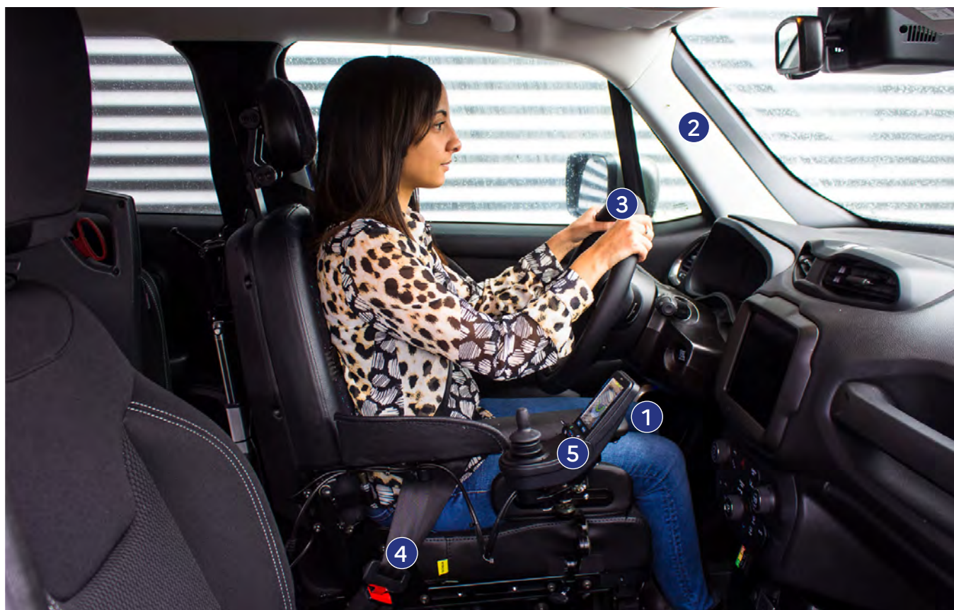
Figure 6 : installation poste de conduite (rang 1)
