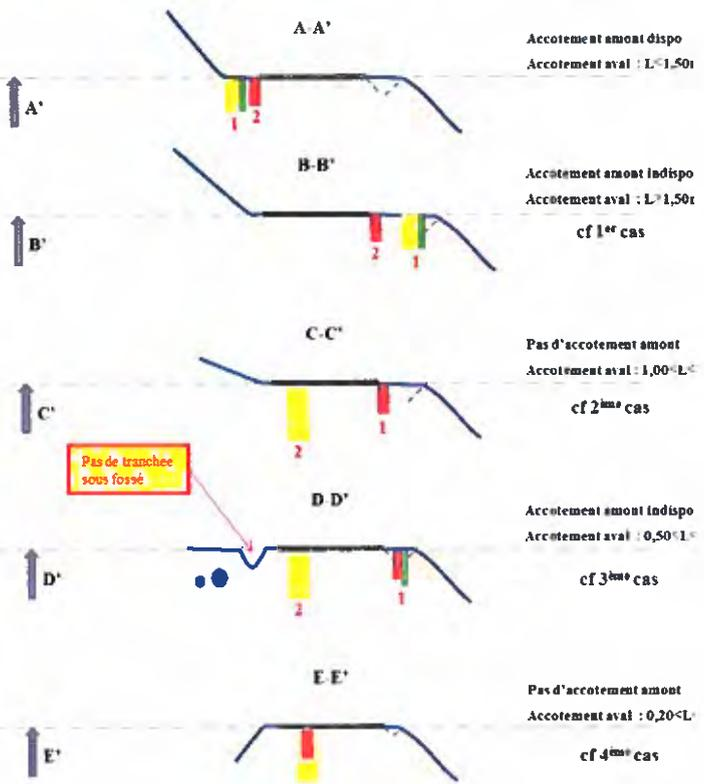
Les tranchées longitudinales sous chaussée doivent être implantées, en priorité, hors passage des roues des véhicules, en principe dans l'axe des voies de circulation (cf annexe n°5).
