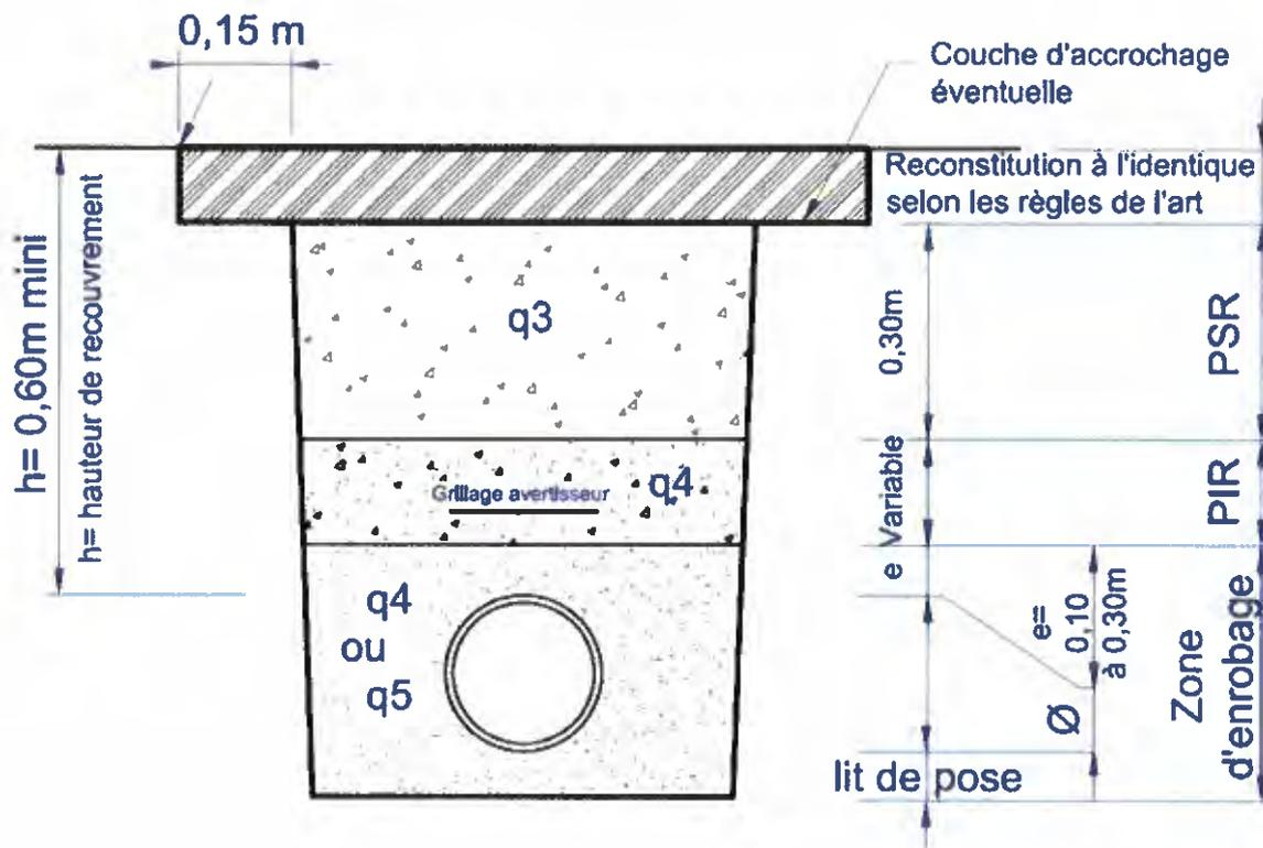
Le remblayage des tranchées classiques sous accotement non revêtu (hors chaussée) doit être effectué conformément à la fiche n°5 annexée à la présente autorisation.
